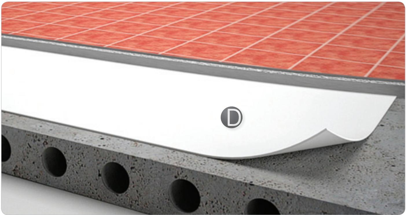
При монтаже края мембраны «Мегаспан D» необходимо завести на стены не меньше чем на 10 см, а после заливки стяжки отрезать лишнее.
