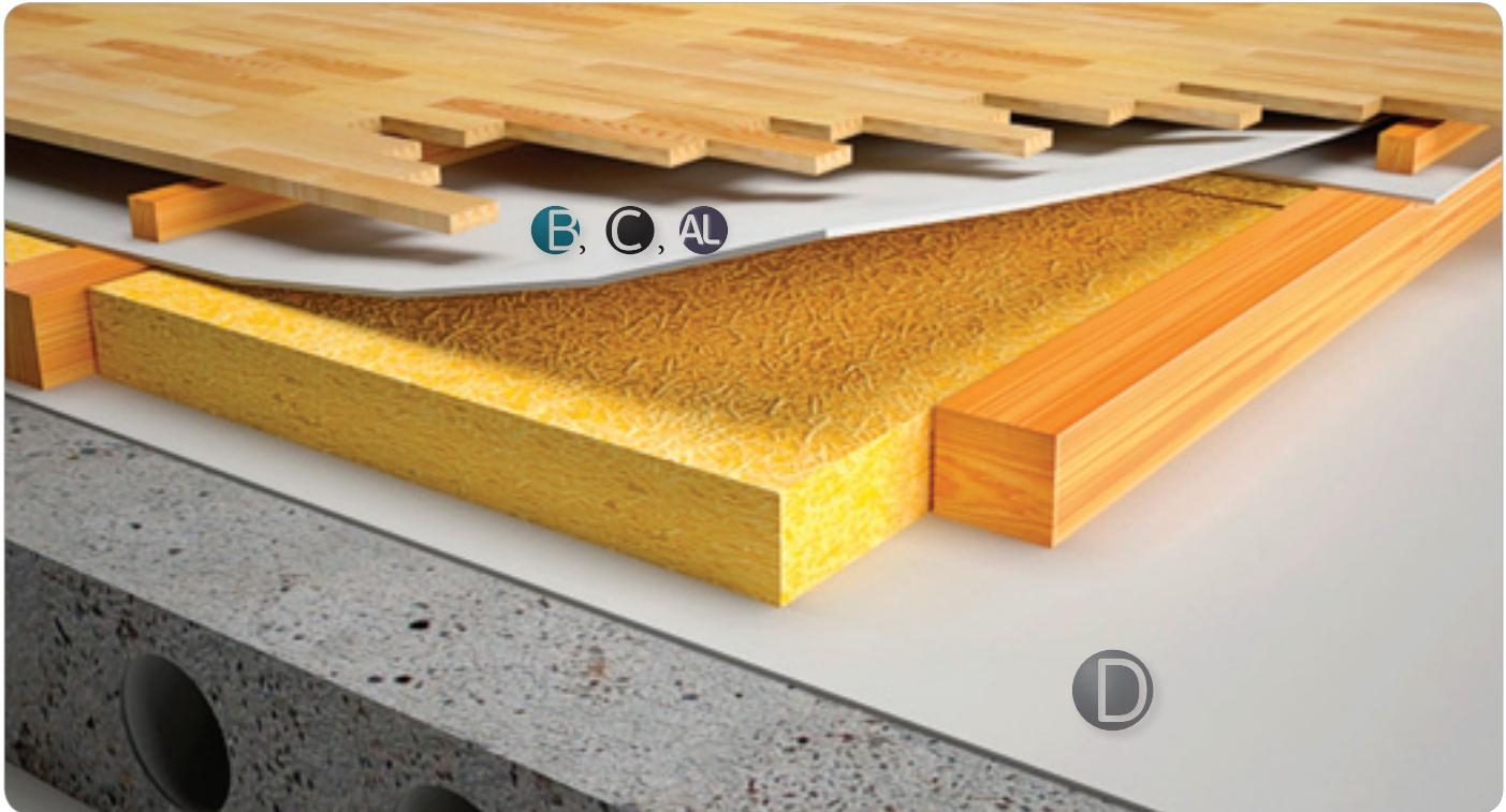
На «Мегаспан D» укладываем под утеплитель и монтируем балки. Для защиты утеплителя от влаги укладываем «Мегаспан В», и закрепляем мембрану строительным степлером к балкам. Балки или утеплитель выбираем таким образом, чтобы между мембраной «Мегаспан В» и утеплителем был зазор 3-4см. Между чистовым полом и мембраной также необходим зазор 3-4см, который образуется толщиной контрейки.
