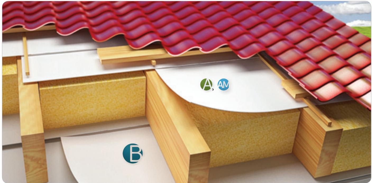
«Мегаспан В» монтируется в натянутом положении по стропилам строительным степлером или оцинкованными гвоздями вплотную к утеплителю гладкой стороной, шероховатой вниз (внутрь помещения). Если вы отделяете мансардное помещение вагонкой, то мембрану закрепляем по каркасу деревянными контррейками, если отделочный материал гипсокартон, то мембрану закрепляем профилем для гипсокартоновых конструкций. Полотна мембранны в местах нахлёста рекомендуем соединить двухсторонней липкой лентой.
