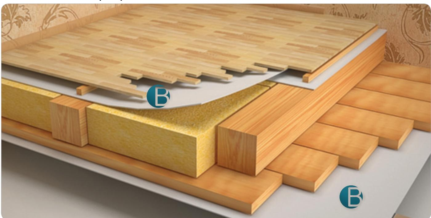
Снизу «Мегаспан В» монтируется на несущие элементы конструкции между черновым потолком и отделочным материалом потолка ворсистой поверхностью вниз. При монтаже поверх утеплителя мембрану укладываем тоже шероховатой стороной вниз (к утеплителю). Между утеплителем и мембраной мы *рекомендуем* обеспечить вентиляционный зазор, который образуется за счёт толщины контрейки монтируемой на стропила.
