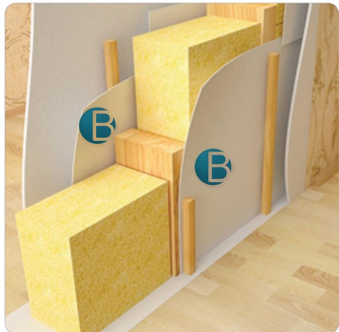
«Мегаспан В» монтируется *без зазора* к утеплителю. Мембрана крепится на несущие элементы конструкции стены строительным степлером или оцинкованными гвоздями. Далее в зависимости от отделочного материала помещения поверх мембраны на несущие элементы конструкции крепятся или деревянные контрейки или профиль для гипсокартона. При монтаже в помещениях с повышенной влажностью рекомендуем места нахлеста полотен скрепить двухсторонней клейкой лентой.
